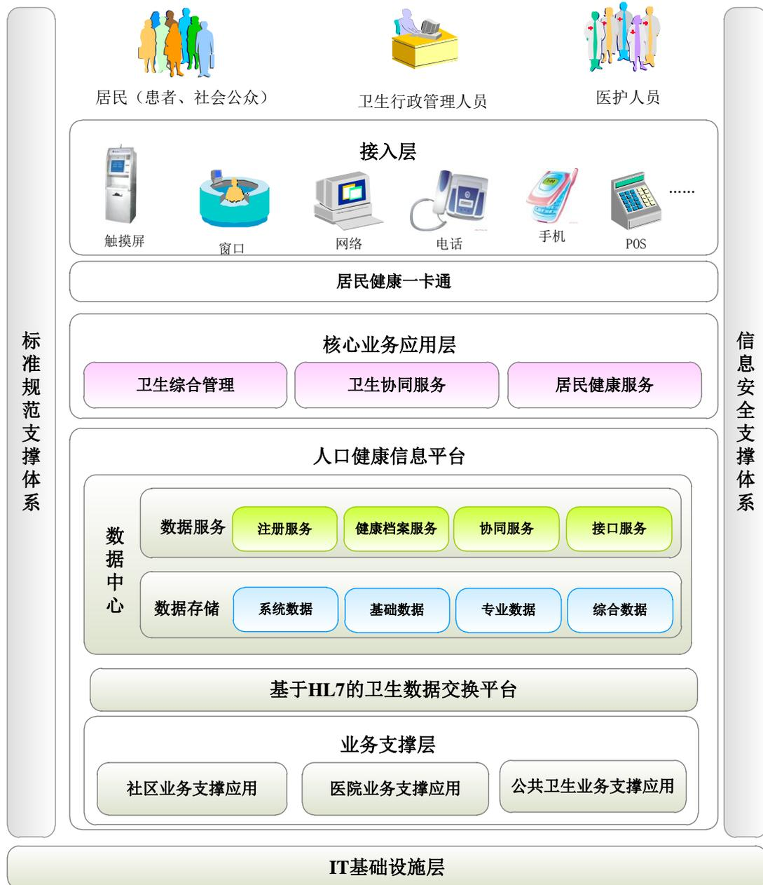
最底层是 IT 基础设备层和左右两层标准规范支撑体系、信息安全支撑体系组成支撑体系，再往上一层是核心层人口健康信息平台，该平台由业务支撑层、卫生数据交换平台、数据中心组成；再上面是架构在人口健康信息平台之上的基于业务数据共享的核心业务应用层，最顶层是外部接入层包括各应用终端；然后由居民健康一卡通贯穿整个医疗健康信息系统。
